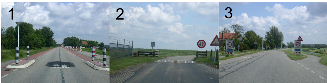
Afbeelding 4.10. Snelheidsreducerende maatregelen zoals gebruikt in Lemsterland: 1) Gumatec-drempel met versmalling door vluchtheuvels met paaltjes (Straatweg); 2) Drempel met optische versmalling door een hekwerk (Grietenydyk en Grietenijdiyk) en 3) Chicane, een combinatie van versmalling en slalom (Krompad).
