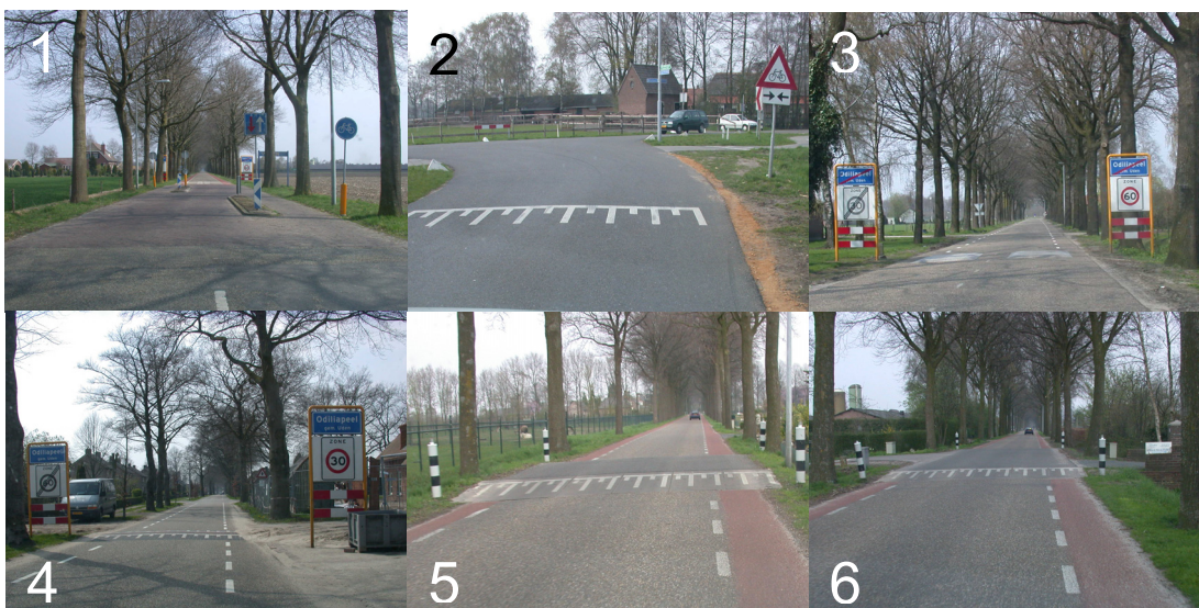
Afbeelding 4.10 Hulpdienst- en ov-vriendelijke (1-2), ov-vriendelijke (3) en hulpdienst- en ov-onvriendelijke (4-6) maatregelen.
