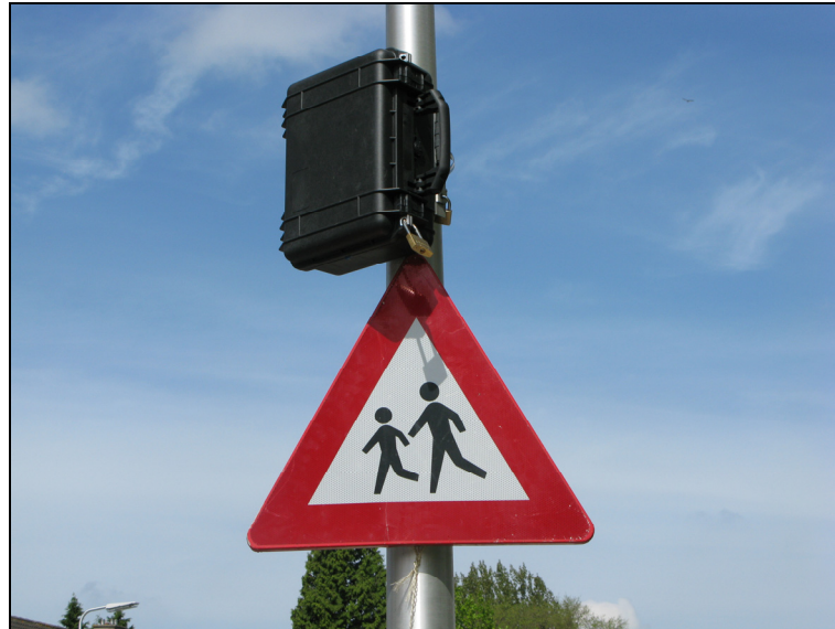
Afbeelding 2.2. Wegkantradar voor het meten van de snelheden van passerende voertuigen.
