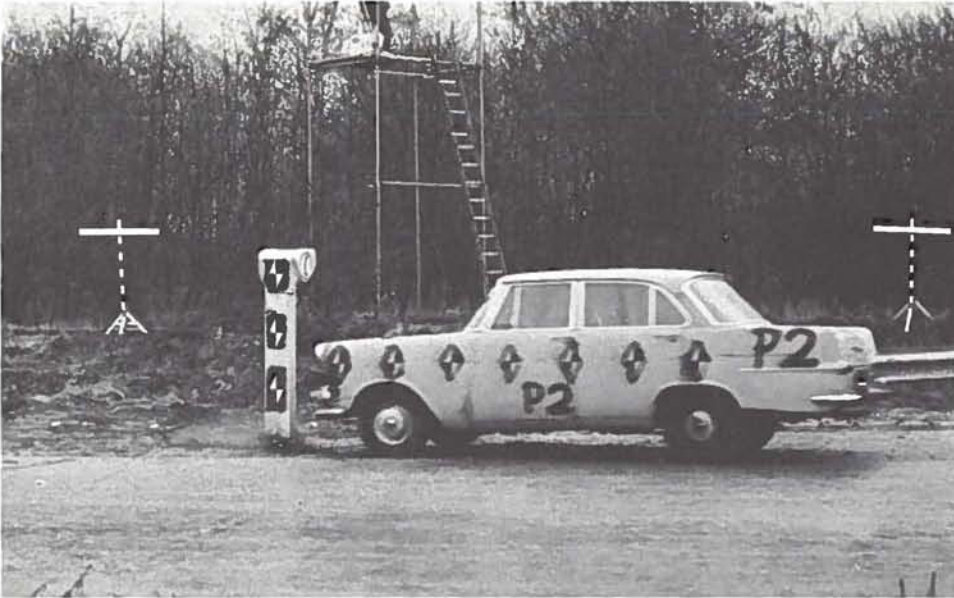
Afbeelding 12. Moment voor de botsing met een praatpaal, beproefd door de SWOV
