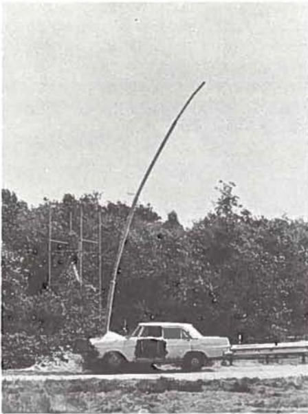
Afbeelding 1. Botsing tegen een 10 m staal lichtmast met 82 km/h, beproefd door de SWOV, 1971
