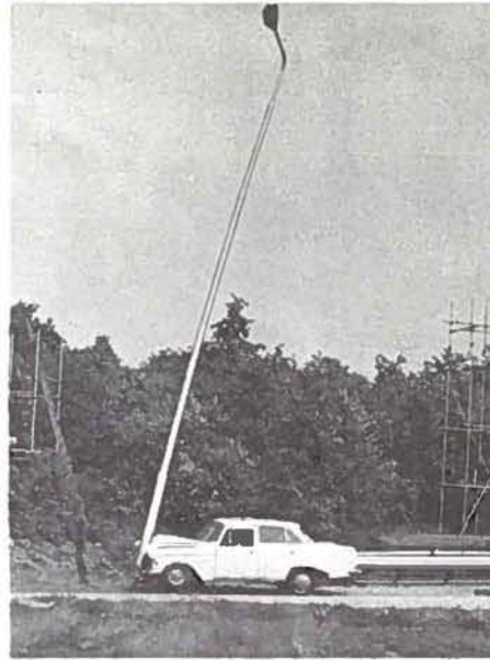
Afbeelding 2. Botsing tegen een 12 m aluminium lichtmast met 70 km/h, beproefd door de SWOV, 1971
