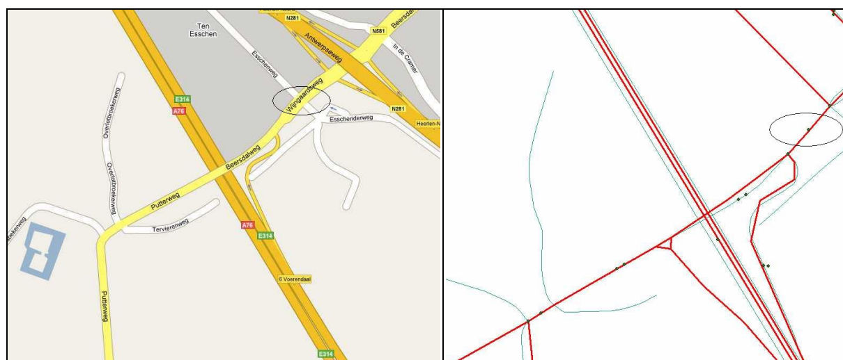
Afbeelding 4.1. Links een voorbeeld van een kruispunt (omcirkeld) in de huidige situatie, en rechts een ongeval op dat kruispunt in het NWB (lichtgrijze lijnen), dat is toegekend aan het modelnetwerk (donkere lijnen; Drolenga, 2007).
