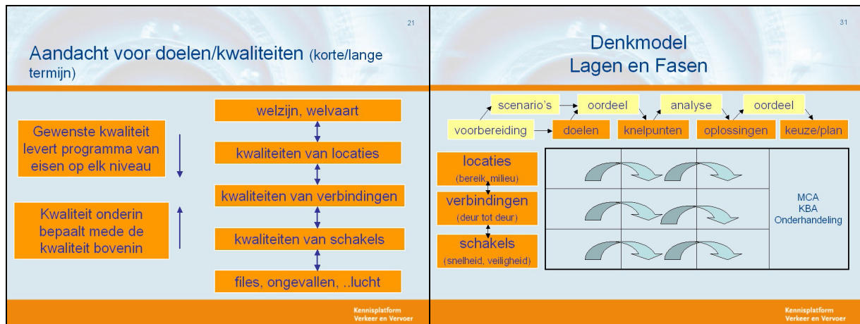
Afbeelding 2.1. Het denkmodel in lagen en fasen. Het model links helpt doelen te formuleren, het model rechts geeft de gefaseerde behandeling van vraagstukken weer (KpVV, 2005; MCA = multicriteria-analyse; KBA = kosten-batenanalyse).
