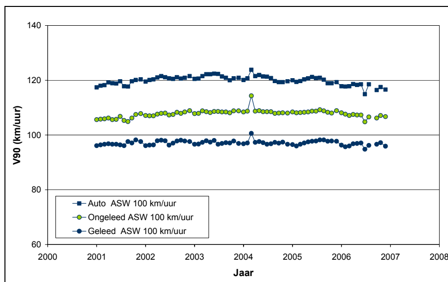
Afbeelding 4.1. V90 van rijsnelheden op rijksautosnelwegen met een limiet van 100 km/uur naar voertuigtype (personenauto, gelede en ongelede vrachtauto; bron: AVV).
