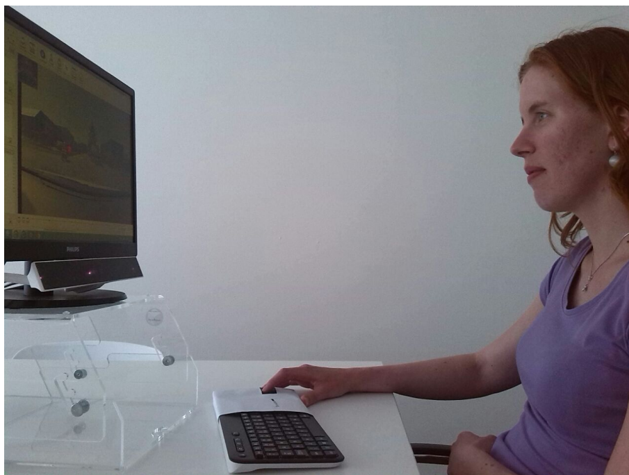
Afbeelding 2.2. Onderzoekopstelling met computerscherm, eronder gemonteerde eye tracker en het toetsenbord met drukknop.
