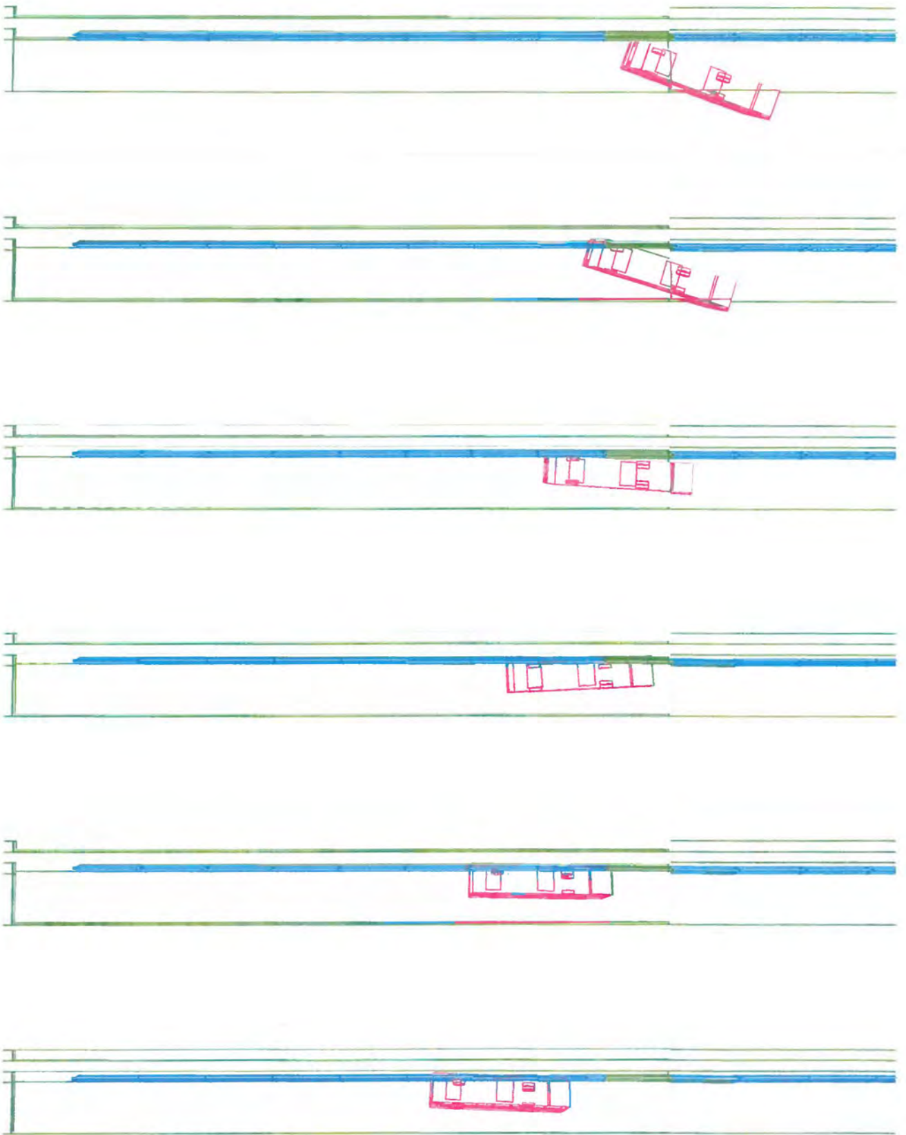
Afbeelding E1. Overzicht aanrijding met de bus tegen de RWS-barrière.
