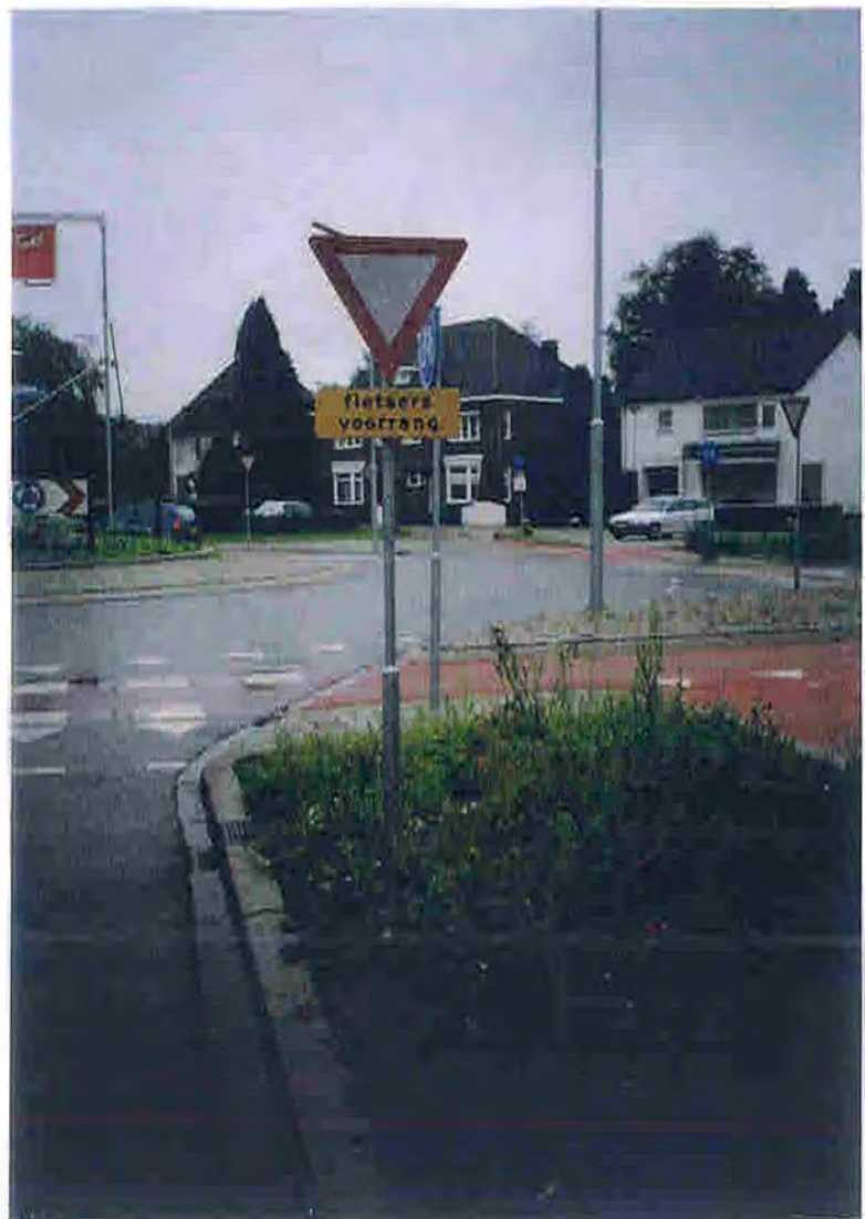
Foto B1.6. Voorrangsbord met onderbord op toerit van de rotonde Venray.
