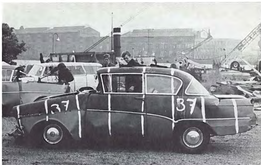
Afbeelding 8 en 9. Vóór- en achterkant mogen vervormen, mits de cabine maar intact blijft.
