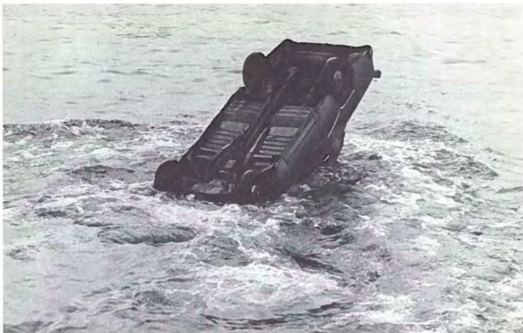
Afbeelding 17 en 18. De meeste voertuigen, die gekanteld te water raken, keren voordat zij zinken eerst nog terug in een vrij horizontale stand.
