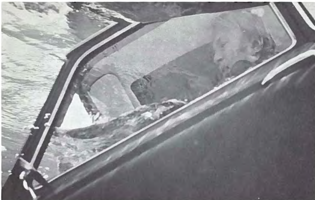
Afbeelding 21. Tijdens het zinken wordt de lucht naar het hoogste gedeelte van de cabine geperst, daardoor kan daar nog even lucht gehapt worden.
