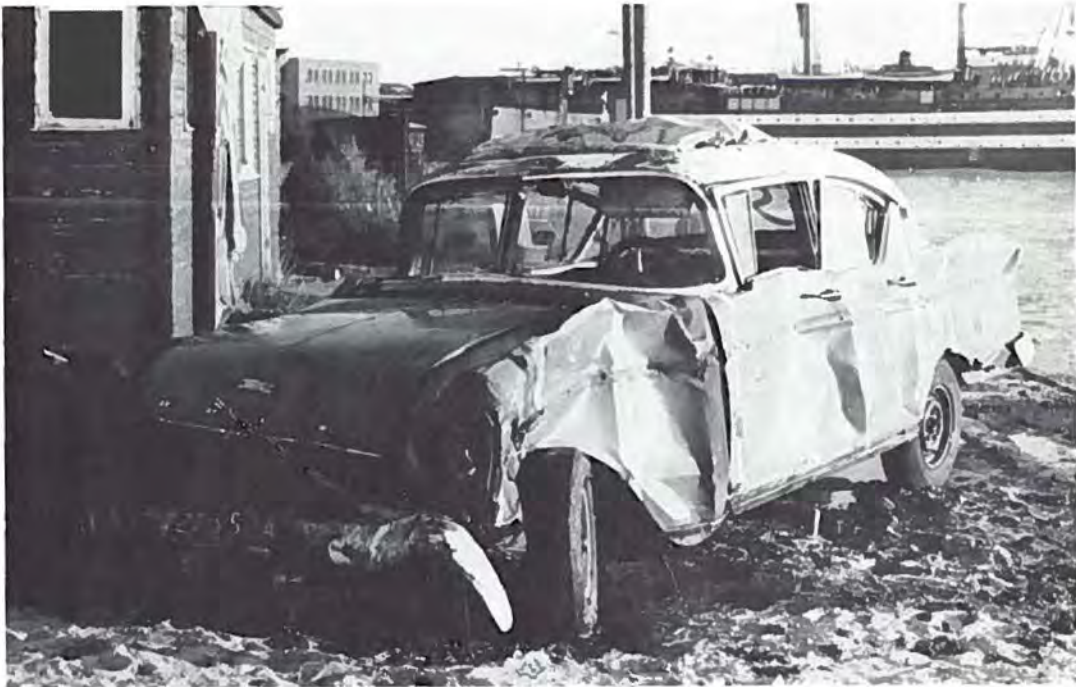
Afbeelding 14. Het gevolg van zijdelings te water raken: alle portieren aan die zijde zijn geblokkeerd.
