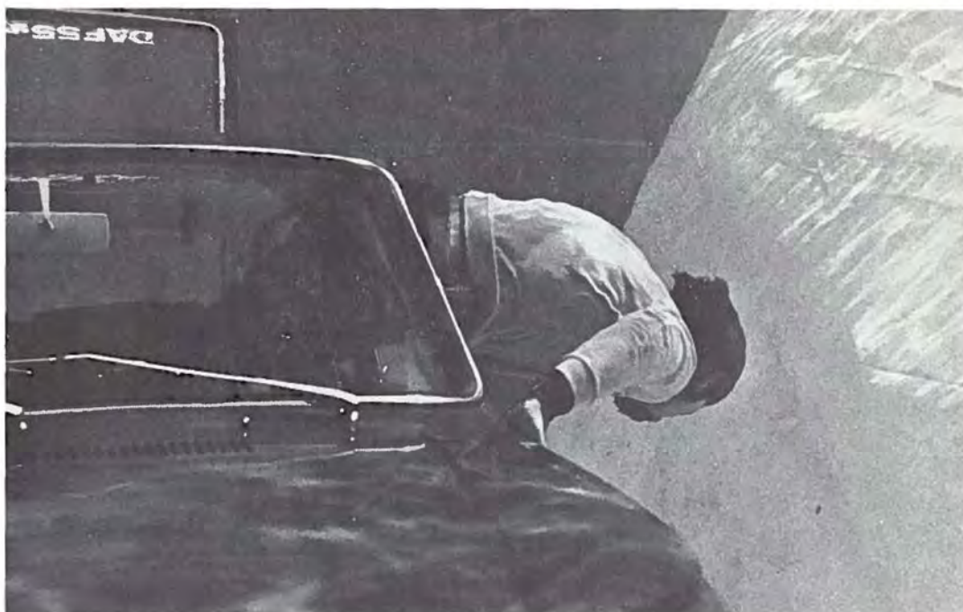
Afbeelding 26. Ontsnapping via een open portierraam is zowel boven als onder water mogelijk.
