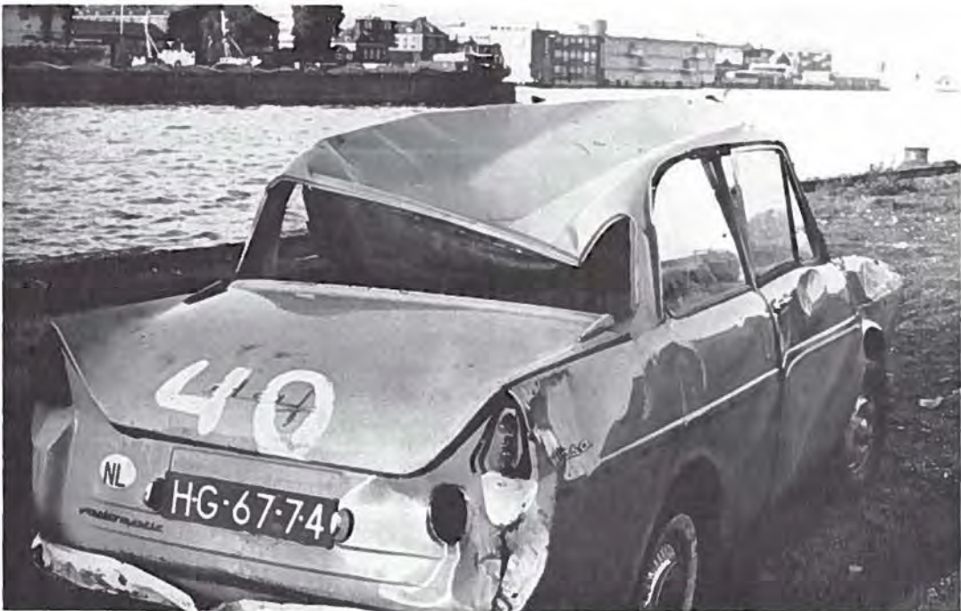
Afbeelding 15. De cabine werd sterk in elkaar gedrukt doordat het voertuig op zijn dak terecht kwam.
