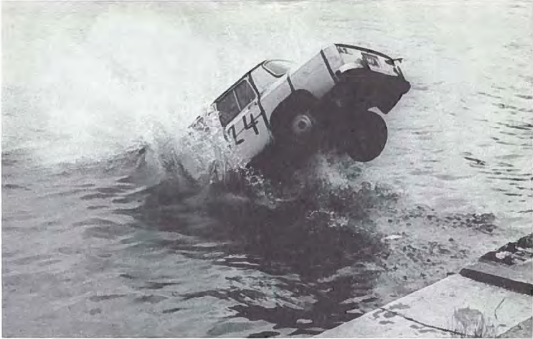
Afbeelding 10. Zelfs bij een inrijshoed van \pm 25 km/h werd bij een hoge walkant reeds een vertraging van 3 à 4 g bereikt.
