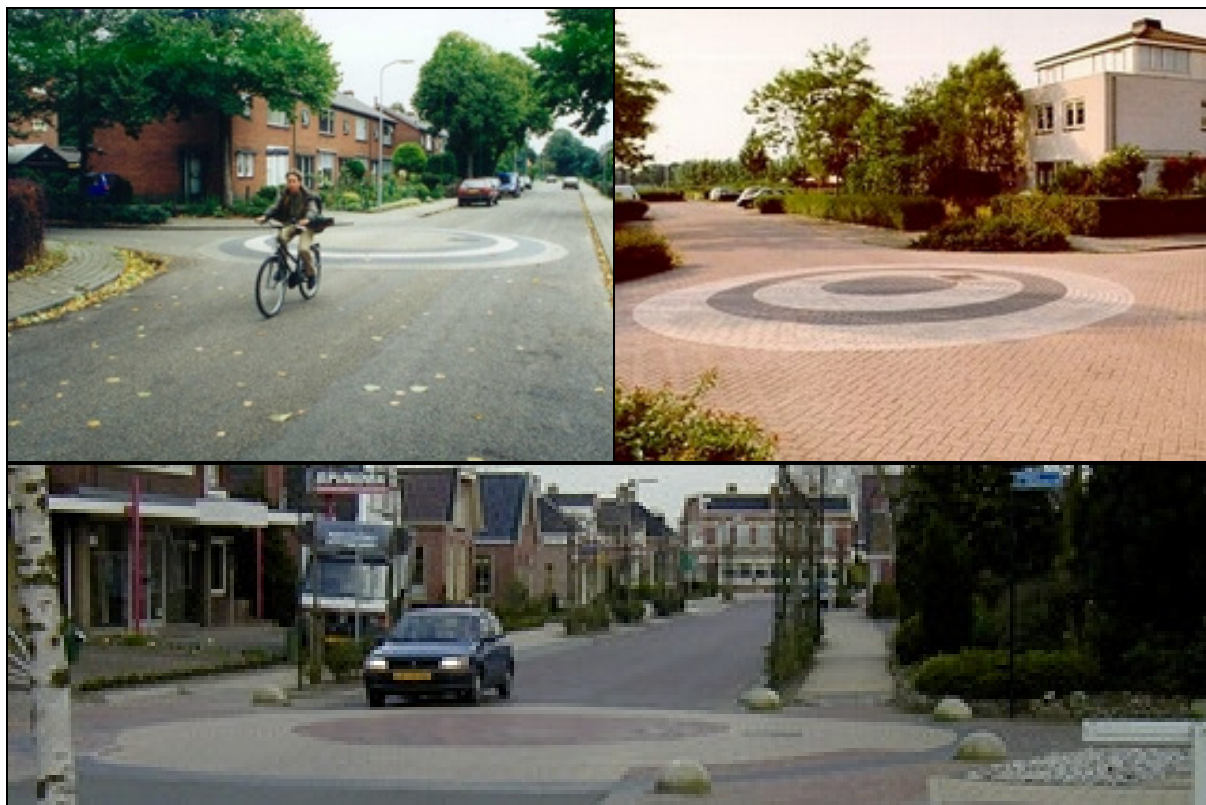
Figuur 2.42 Snelheidsremmende 'punaises' benadrukken de gelijkwaardigheid [ www.crow.nl/duurzaamveilig ]
