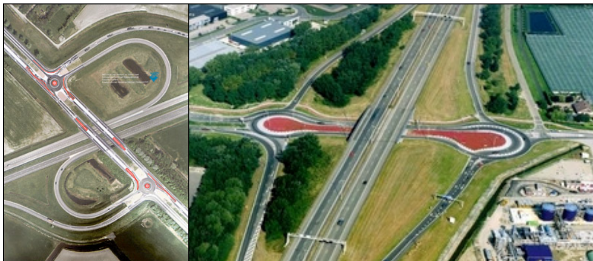
Figuur 2.29 Links: Halfklaverblad-aansluiting van de N57 op de A58 bij Middelburg [ www.rovz.nl/infrastructuur ] Rechts: Haarlemmermeer-aansluiting met kluifrotonde [ www.crow.nl/duurzaamveilig ]
