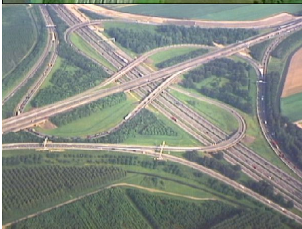
Figuur 2.15 Voorbeeld van een windmolen-knooppunt: Knooppunt Vaanplein [www.beeldbankvenw.nl]
