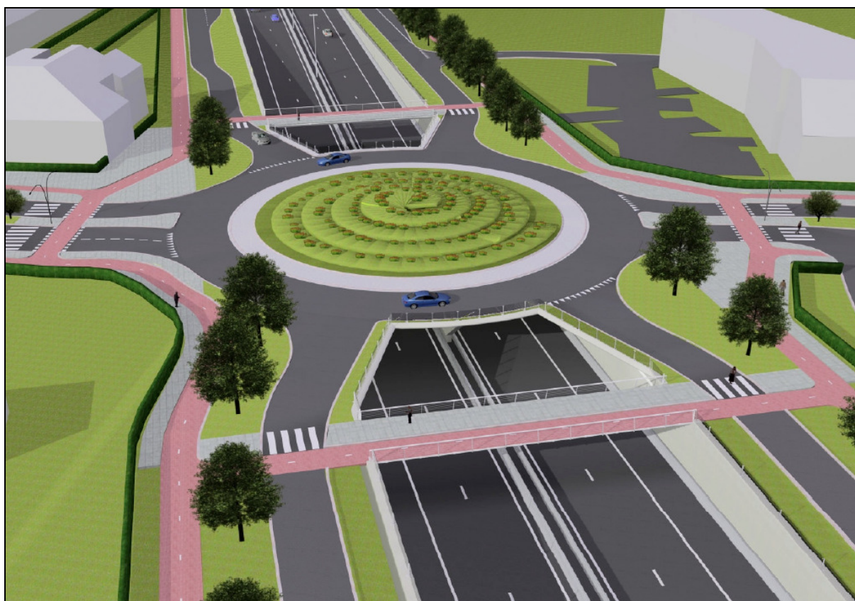
Figuur 2.30 Ontwerp voor herinrichting van een zwart punt: Kruispunt N31 - Koningin Astridlaan [ www.brugge.be ]
