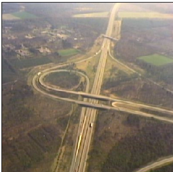
Figuur 2.13 Voorbeeld van een T-knooppunt: Knooppunt Grijsoord [www.beeldbankvenw.nl]
