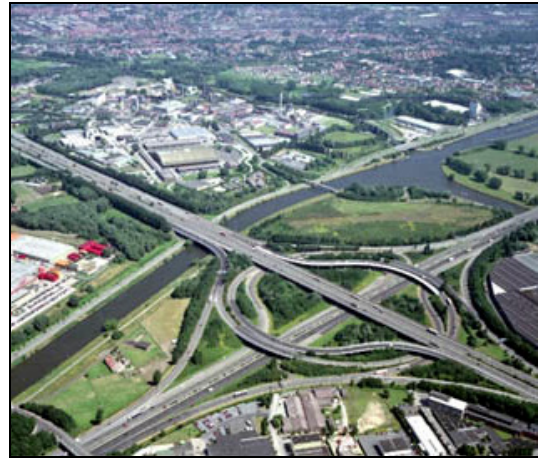
Figuur 2.16 Voorbeeld van een turbine-knooppunt: Verkeerswisselaar Zwijnaarde [home.tiscali.be/guidocoolens]
