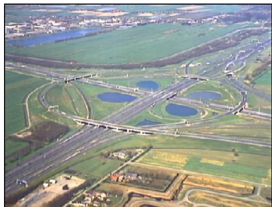
Figuur 2.18 Voorbeeld van een klaverturbine: Knooppunt Oudenrijn [www.beeldbankvenw.nl]
