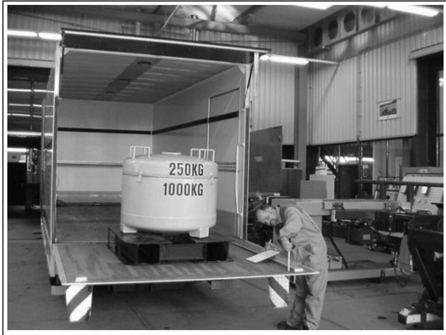
Afbeelding 1. Een voorbeeld van vlaggen onder de laadklep en lampjes op de hoekpunten (bron: RAI/FOCWA: www.lpk.nl ).
