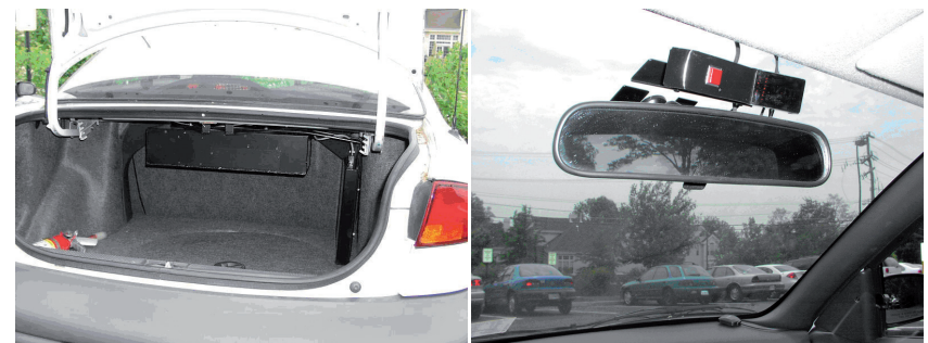
Afbeelding 4+5. Waarnemingsapparatuur gebruikt in de 100 Car Study in Virginia.
