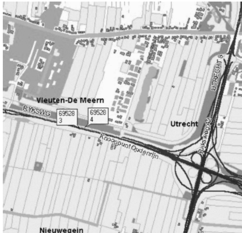
Afbeelding 21. Wegdeel op de A12 bij het knooppunt Oudenrijn bij Utrecht, met drie rijstroken in oostelijke richting en vier in westelijke richting en gelijk toegedeelde etmaalintensiteiten.
