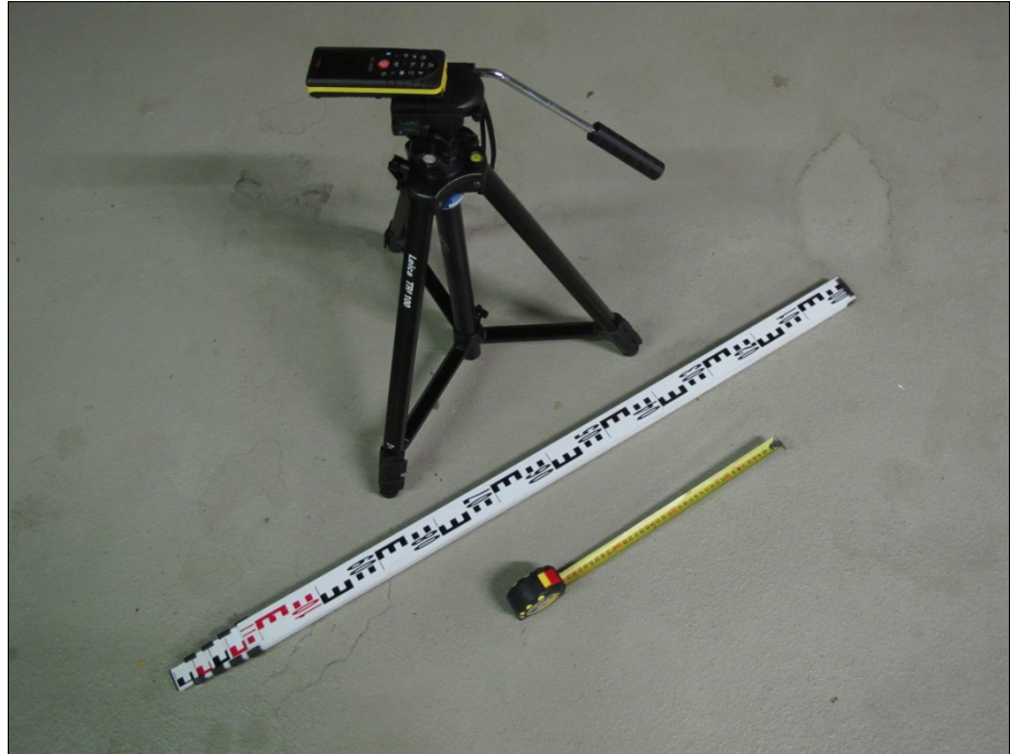
Afbeelding 2.2. Apparatuur die bij de wegininspecties is gebruikt om afstanden te meten. Achteraan het statief met de Leica Disto D8 laserafstandsmeter, daarvoor de E-baak en de rolmaat.
