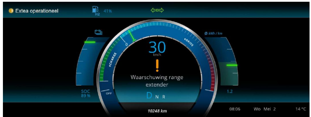
Afbeelding 3 Informatiepaneel van de Citea-bus. Informatie over de Extea-aanhanger wordt gepresenteerd in de bovenste blauwe balk (bron: VDL-document Chauffeursinstructie - Instrumenten en bediening).
