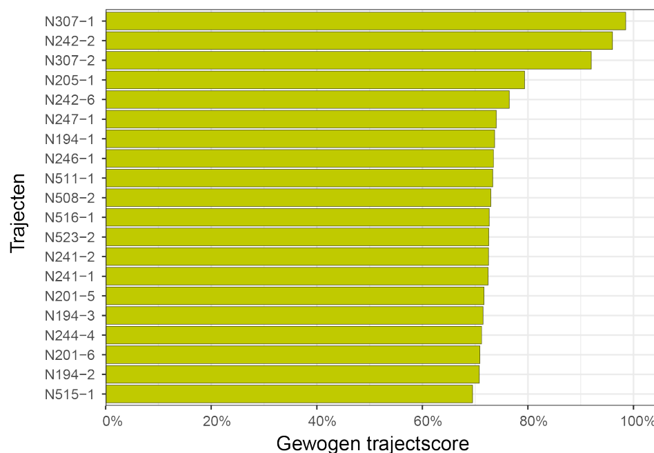
Afbeelding 5.5. Hoogst scorende trajecten op het gewogen gemiddelde tussen de rijbaanscores en kruispunt scores. De maximale score is 100%. De weegfactoren van 0,54 en 0,46 zijn gebaseerd op de verhouding van het aantal waargenomen ongevallen op rijbanen en kruispunten.
