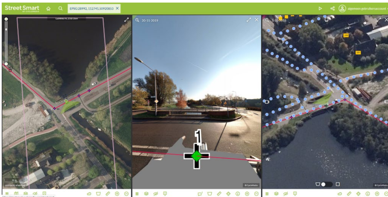
Afbeelding 2.3 Voorbeeld van beelden uit Cyclomedia voor een bepaald meetpunt. Links is het bovenaanzicht van het meetpunt en de naaste omgeving zichtbaar, in het midden de situatie op het meetpunt en rechts de overige beschikbare meetpunten in de omgeving van het meetpunt. Uit: Handleiding voor annoteurs, versie april 2020. Uit: Cyclomedia/StreetSmart handleiding
