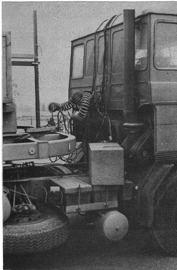
Afbeelding 5. De vertraging tijdens een remming is gemeten met een versnellingsopnemer. De opnemer was in een kist op de trekker geplaatst.
