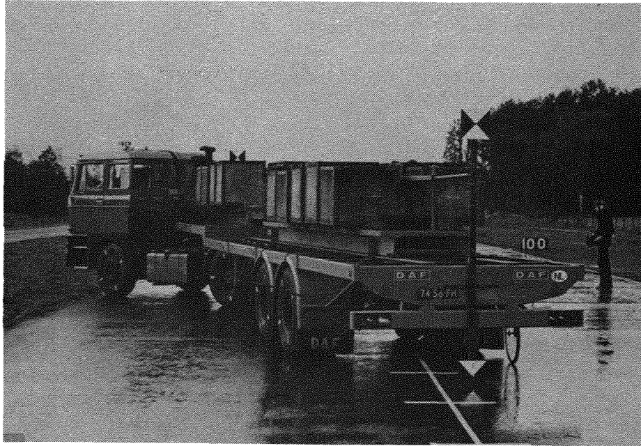
Afbeelding 7. Voorbeeld van een remproef met de volbeladen combinatie. Aan het eind van de meting is de positie van de combinatie geschetst t.o.v. de lengtes van de weg.
