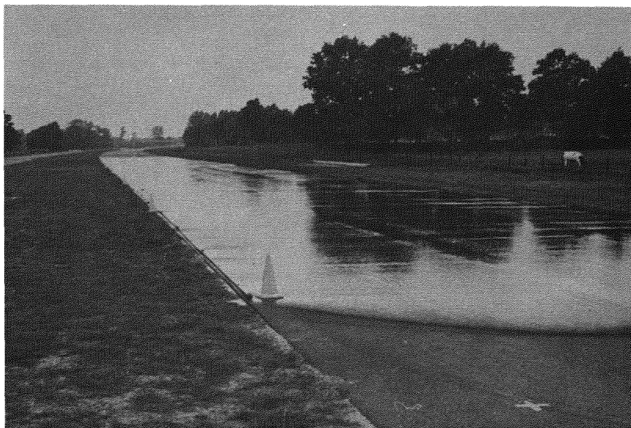
Afbeelding 3. Een gedeelte van het meettraject. Door middel van een sproei-installatie kon een gedeelte van het traject permanent nat gehouden worden.
