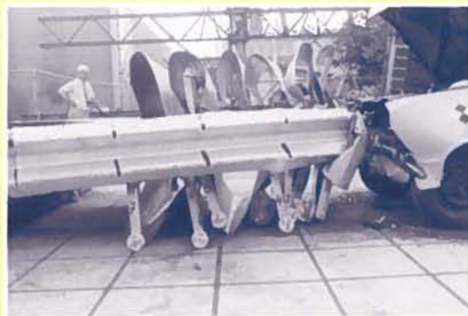
Botsproef tegen een rimpelbuisobstakelbeveiliging
