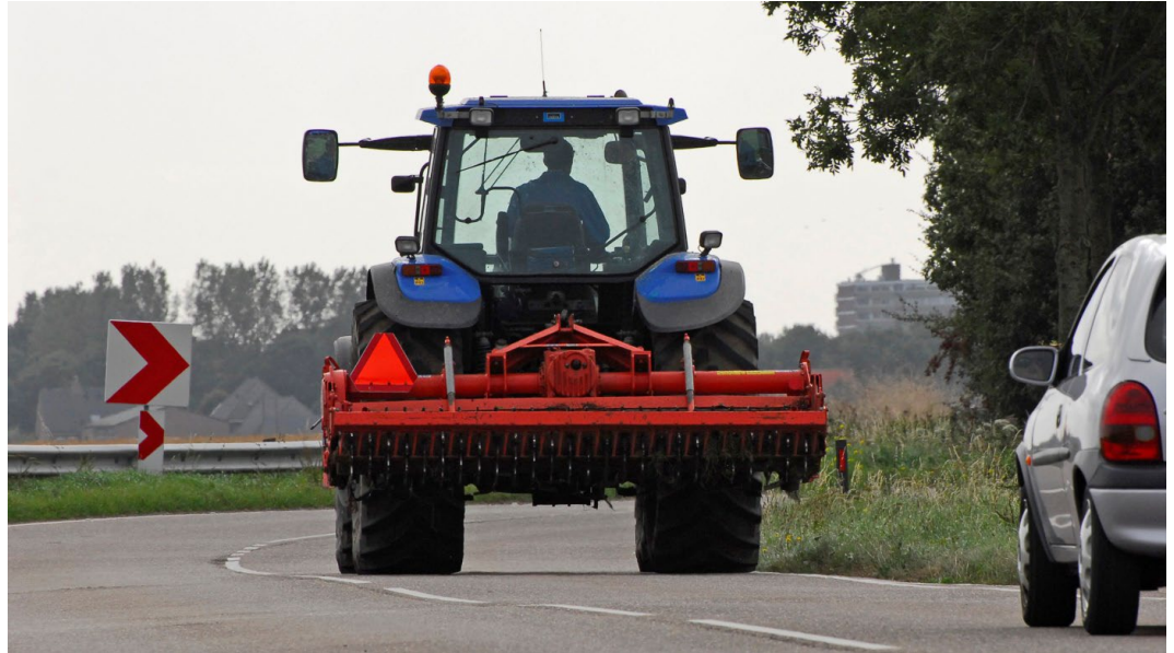
Afbeelding 3. Tractor met werktuig (eg), zwaailicht en linksachter de retroreflecterende, afgeknotte driehoek (foto: H. Dijkema).
