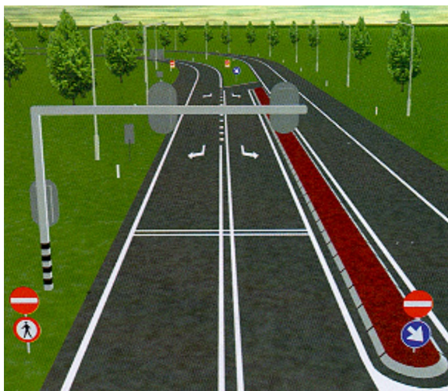
Afbeelding 4.3. Correctieweg die ervoor zorgt dat een automobilist die de afrit in plaats van de toerit oprijdt, automatisch naar de toerit wordt geleid. De rijstrook voor verkeer dat afslaat naar links, gaat in de andere richting via een doorsteek over in de toerit (Bron: RWS Zuid-Holland/Grontmij in Brevoord, 1998).
