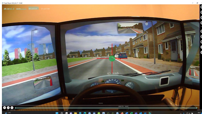
Afbeelding 2.3. Videobeeld van de 'wereldcamera' met daarop geprojecteerd het vizier dat aangeeft waar de bestuurder op dat moment naar kijkt.
