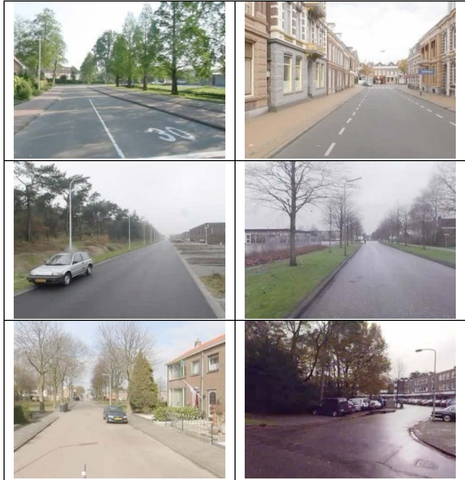
Afbeelding 6.3. Voorbeelden van wegen die geen geloofwaardige snelheidslimiet hebben. De scores volgens de VSGS zijn van boven naar beneden en van links naar rechts: 6, 6, 5, 4, 4, 3. In alle gevallen zou de snelheidslimiet hoger moeten zijn.
