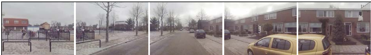
Afbeelding 9.1. Een voorbeeld van een ongevalslocatie waar onvoldoende maatregelen zijn genomen gericht op veilig oversteken. Bij een basisschool aan de ene zijde van de straat is wel de mogelijkheid om over te steken, maar aan de overzijde is ruimte voor een lange rij geparkeerde auto's.
