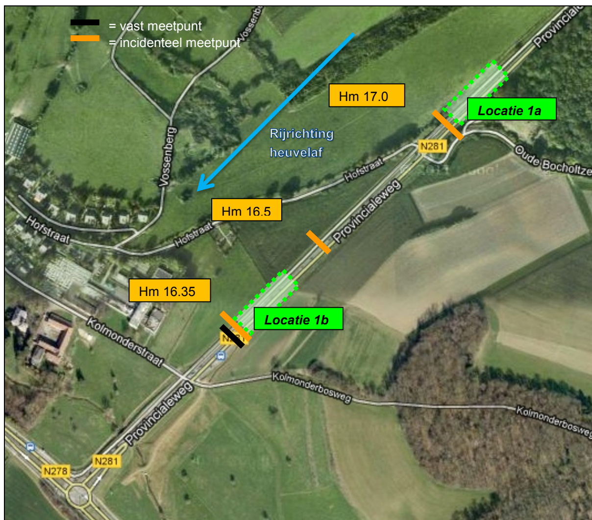
Afbeelding 1.1. Bovenaanzicht van de N281 bij Baneheide, met daarin aangegeven de locaties waar Natuurlijk Sturen-maatregelen zijn voorzien (groen gestippelde vakken) en de globale locaties waar snelheidsmetingen zijn gehouden (oranje strepen), met daarbij aangegeven de nummers van de meetpunten, gekoppeld aan de hectometerpaal (Hm). Op het hele aangegeven wegvak is de snelheidslimiet 80 km/uur.
