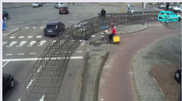
Afbeelding 5: Voorbeeld van objectdetectie: detectie van verkeersdeelnemers en het volgen van hun beweging over een kruispunt (foto's TNO).
