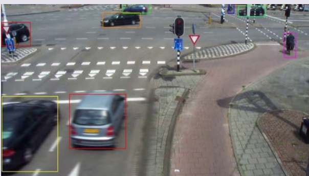
Afbeelding 5: Voorbeeld van objectdetectie: detectie van verkeersdeelnemers en het volgen van hun beweging over een kruispunt (foto's TNO).
